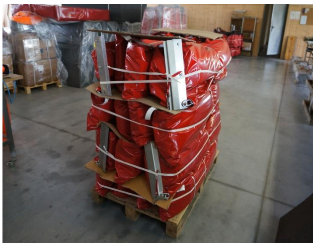
Zapora przeciwolejowa typu Finboom zapakowana na palecie do wysyłki
