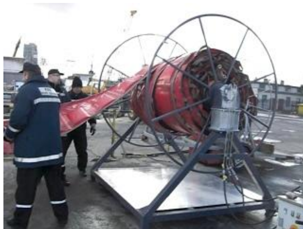
Zwijadło typu ZZ-400/M napędzane silnikiem hydraulicznym z zaporą
