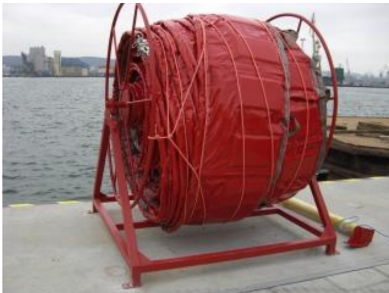
Zwijadło do zapory przeciwolejowej z napędem ręcznym ZZ-200 z nawiniętą zaporą o długości ok. 200m
